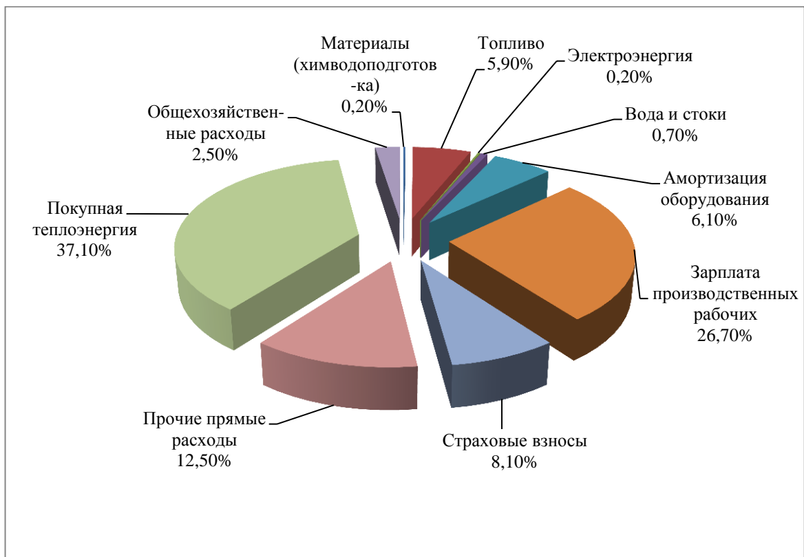
Рисунок 1.11.4. Структура себестоимости производства и транспортировки тепловой энергии ФГУП «НИТИ им. А.П. Александрова» в 2014 году
