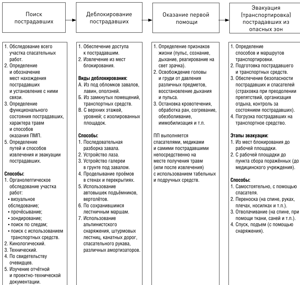
Рис. Л3. Принципиальная организационно-технологическая схема проведения поисково-спасательных работ
