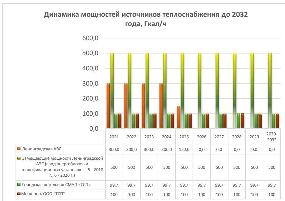
Рисунок 12. Динамика изменения мощности источников теплоснабжения муниципального образования Сосновоборский городской округ Ленинградской области в период с 2021 по 2032 годы
